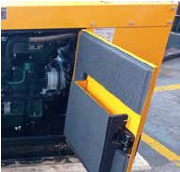
Cabina insonorizada con espuma de alta densidad para bajo nivel de ruido.
